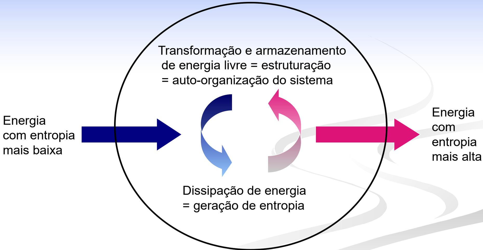
**Observação: todo sistema termodinâmico isolado tende ao equilíbrio, atingindo um máximo de entropia**
